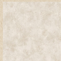
Muros interiores Aplanado a base de pasta tipo Chukum en muros y plafones de 3 a 5 mm.
